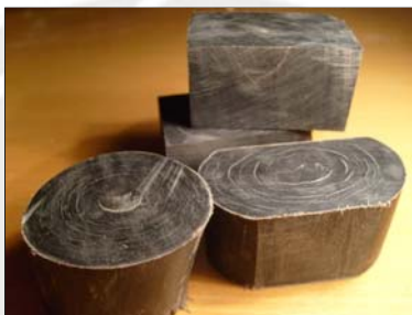
Materialfehler im Horn ("Jahresringe")
