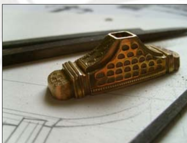
Fertig punzierter Knauf vor dem Vergolden
