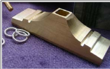
Knaufrohling nach dem Herausarbeiten der oberen Konturen
