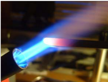
Härten der Prantel mittels Gasbrenner nach der Bearbeitung
