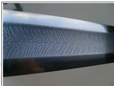
Durch weitere Politur wird das Muster kontrastreich
