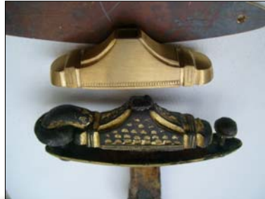
Kontrolle der Proportionen anhand des Originalknaufes
