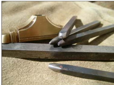
Die Punzstempel nach der Anfertigung
