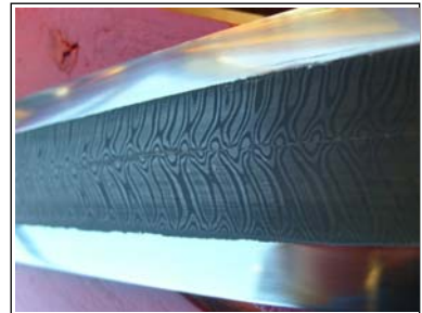
nach der groben Politur wird erstmals das Muster sichtbar
