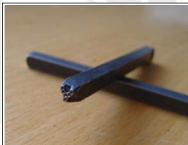
Der fertige Punzstempel in charakteristischer Y-Form
