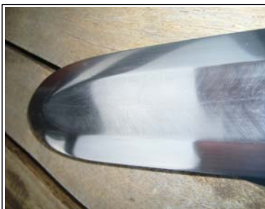
Die rekonstruierte Klinge geschliffen und poliert vor dem Ätzen
