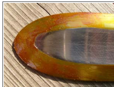
Die Schneiden der Klinge sind mit einem Schutzfilm überzogen
