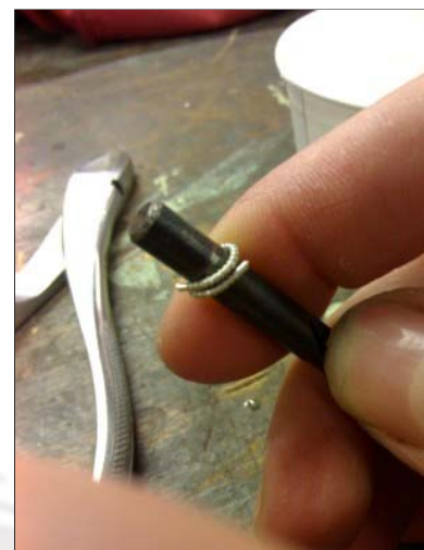
Umwickeln eines Schaftes um den richtigen Durchmesser zu erreichen
