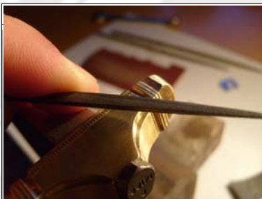
Einfeilen der Rillen mit der Messerfeile
