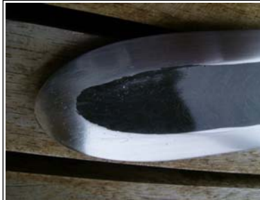
Die Klinge nach dem Ätzen. Der Schutzfilm wurde entfernt
