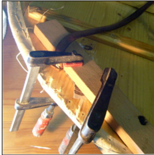
geleimter und geschmierter Schildkörper
